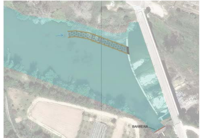
Ubicació de la rampa i de la barrera per evitar l'entrada dels peixos al canal de derivació
