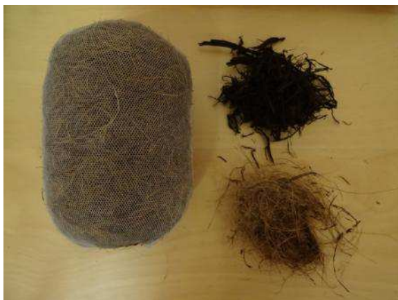
Figura 3; a) Modelo de los paquetes que se introducirán en los canales con fibra de coco o xylit (cedidos por la empresa Salix) en su interior; b) fajina de madera de avellano.
