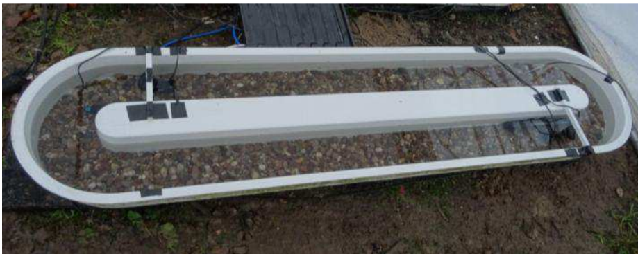
Figura 1: a) Visión general de los canales donde se llevará a cabo el experimento; b) Detalle de uno de los canales con lecho de grava.
