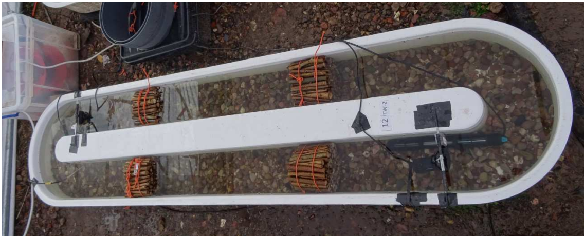
Figura 2: Canal con fajinas de ramas de avellano.
