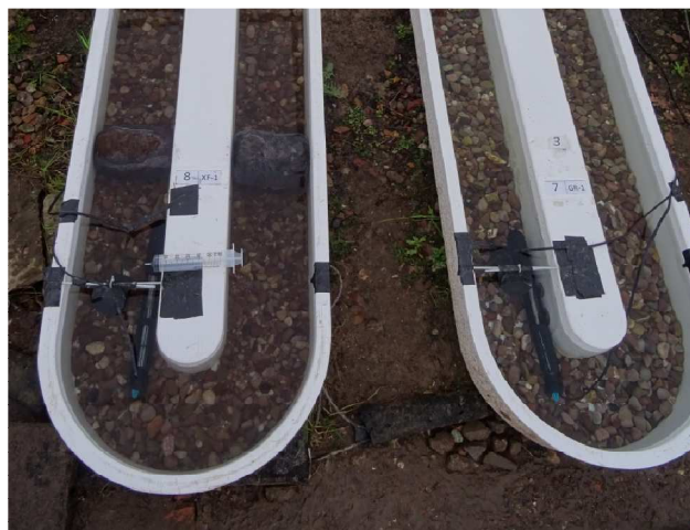
Figura 1: Detalle de dos canales: a la derecha con paquetes de xylit y a la izquierda control sólo con grava
