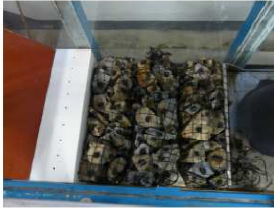
Figura 3. Gaviones flexibles en el canal experimental
