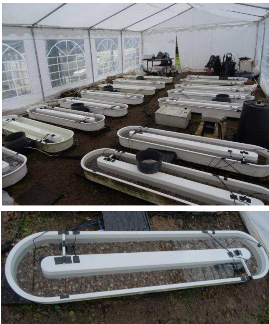
Figura 1: a) Visió general dels canals on es durà a terme l'experiment; b) Detall d'un dels canals amb llit de grava.
