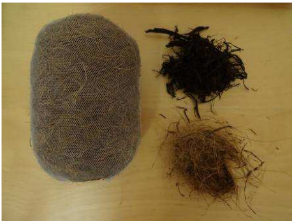
Figura 3; a) Model dels paquets que s'introduiran als canals amb fibra de coco o xylit (cedits per l'empresa Salix) al seu interior; b) feixina de fusta d'avellaner.
