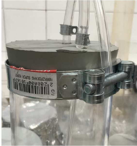
Muntatge dels tubs d'irrigació i extracció.
