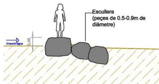
Tall transversal del pas en pedra (exemple)
